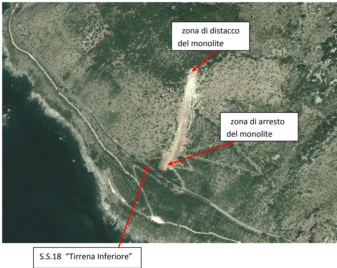
Foto n°15 – punto di arresto dello scivolamento del monolite con in primo piano il terreno ed i detriti che ha scavato e trascinato a valle per l'effetto ruspa.
